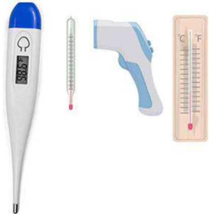
ሥዕል 2.13: የተለያዩ የቴርሞሜትር ዓይነቶች በአብዛኛው ጊዜ ቴርሞሜትር በሴንትግራድ ይገለጻል፤ ይሁን እንጂ የተማከለ የመጠነ-ሙቀት አሃድ ኬልቪን ነው።
